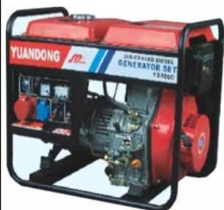
Дизельные электрогенераторы YD имеют выходное напряжение 220В/50Гц, коэффициент мощности  $\cos\phi=1,0$ ; дополнительное выходное напряжение 12В/ 8,3 А для зарядки аккумуляторов. Генераторы 2-х полюсные с медными обмотками, оснащены щеточным узлом. Генераторы оборудованы дизельным одноцилиндровым 4-х тактным двигателем, воздушного охлаждения, смонтированы на прочной стальной раме.
