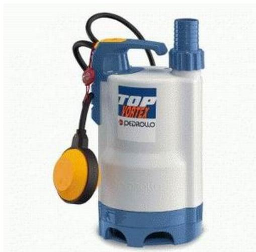
Насос TOP-VORTEX рекомендуется для подъема загрязнённых вод и химически неагрессивных жидкостей. Используемые конструктивные решения обеспечивают простоту в эксплуатации и безопасность благодаря полному охлаждению двигателя и двойному механическому уплотнению. Насос рекомендуется для применения в быту, для подъема загрязненных вод, осушения бассейнов, сливных колодцев и приямков, отвода бытовых стоков, в том числе при наличии во взвеси твердых частиц диаметром до 20 мм.
