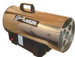
Газовые тепловые пушки — мобильные установки для обогрева помещений больших площадей, не требующие значительной мощности электросети. Незаменимы для обогрева складов, ангаров, временных строений в полевых условиях и в условиях ЧС. Вид топлива – сжиженный газ. Достоинства: тепловая мощность выработанная в тепловой пушке полностью передается отапливаемому помещению; возможность использования электроэнергии от бензиновых или дизельных электрогенераторов малых мощностей (напряжение – 220 В).
