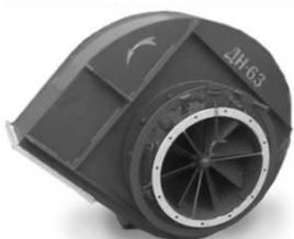
Дымососы центробежные одностороннего всасывания типов ДН (с направляющим аппаратом) и Д предназначены для перемещения (отсасывания) дымовых газов из топок котельных агрегатов, оборудованных системами золоулавливания с запыленностью не более  $2 \text{ г/м}^3$  и температурой не более  $200^\circ\text{C}$ .
