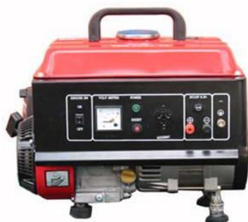
Электрогенераторы YG 1100 оснащены 2-х тактным одноцилиндровым бензиновым двигателем с воздушным охлаждением. В качестве топлива используется смесь бензина марки АИ-92 с маслом для двухтактных двигателей в соотношении 50 частей бензина к 1 части масла.
